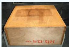
平成16年11月、水槽内の水を捨て、ガーディアンのコンパネの接着状態をチェックしましたが、剥離の兆候は全くありませんでした。次に、コンパネの水槽をひっくり返し、各箇所の水漏れをチェックしましたが、全く漏水はありませんでした。
