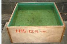
ガーディアンを水槽に見立てたコンパネの箱の内側にローラーで2度塗りをし、2日間、自然乾燥させた後、水道水を高さ150mmまで注入し、屋外に放置しました。
